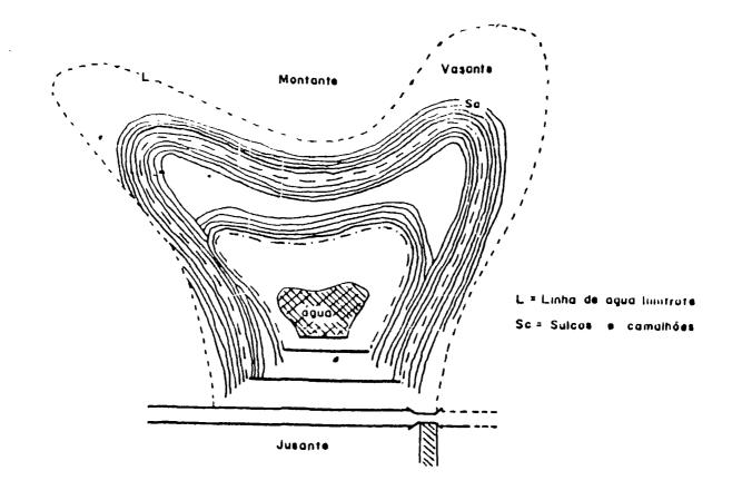
Modelo esquemático do sistema de vazantes de açudes
