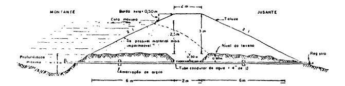
Modelo esquemático do dimensionamento da parede do barruiro e tecação de tubo condutor de água.
