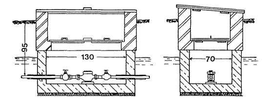
Fig. 1. Typical meter box
