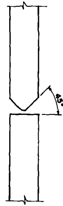
D DOUBLE - BEVEL GROOVE WELD
